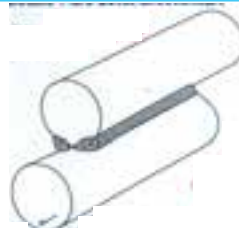
جوش شیاری V شکل لبه برگردان دوطرفه
